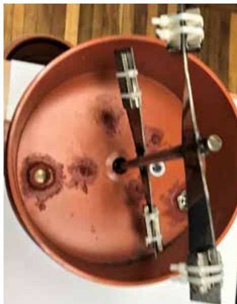
Рис.2.5. Закріплення постійних магнітів на перемішувальному вузлі
