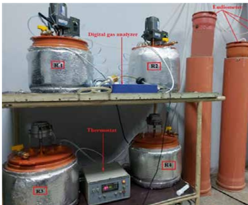
Рис.2.3. Експериментальна установка для досліджень процесів біометаногенезу під керованою дією теплового, магнітного та електричного полів і механічних коливань
