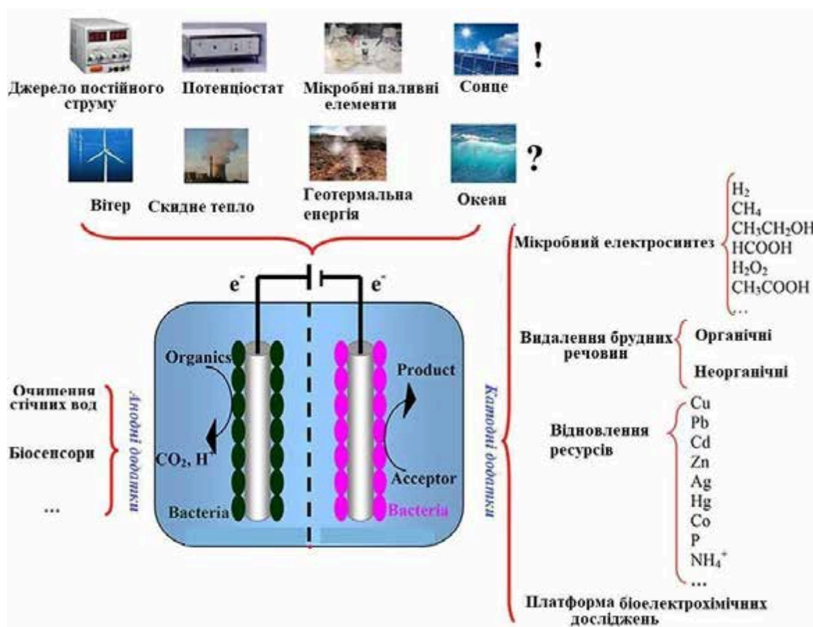
Рис. 1.2. МЕК як платформа біоелектрохімічних застосувань
