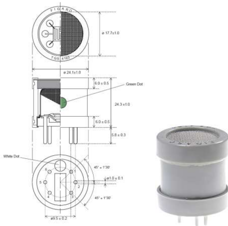
Рис. 3.4. Габаритні розміри та зовнішній вигляд датчика TGS4160
