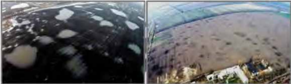
Рис.1. Наповнення мікрозападин водою при сніготаненні (зліва) та неоднорідність зволоження ґрунту (справа). Знімки дроном (БПЛА) Фантом-4.
