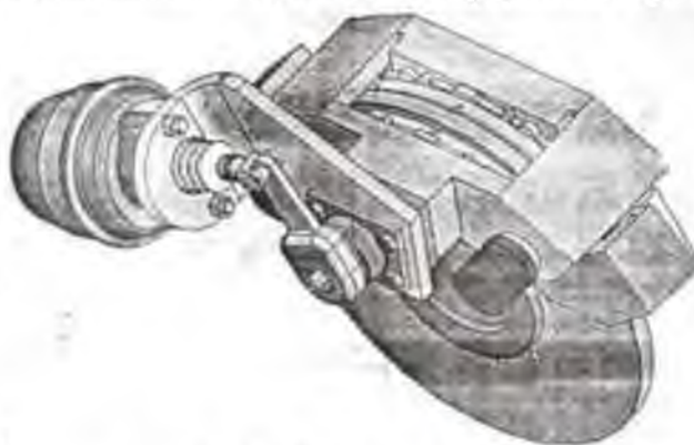
Рисунок 1.6 Дисковий гальмівний механізм із гвинтовим приводом
