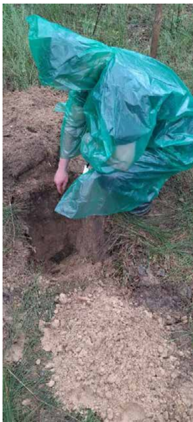
Рис. 2.6. Процес закладання ґрунтового розрізу та відбору зразків у польових умовах поблизу смт Народичі, Житомирська область.
