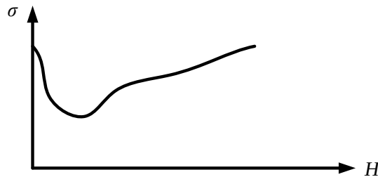
Рисунок 2.16 – Характеристика дуги залежно від напруженості магнітного поля
