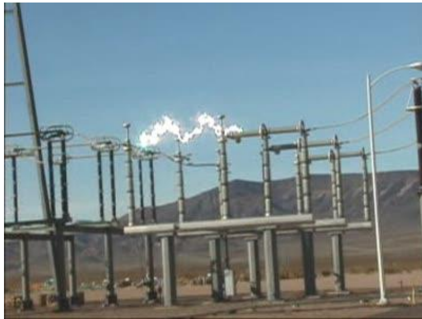
Рисунок 5.2. - Дуговий розряд між контактами роз'єднувача
