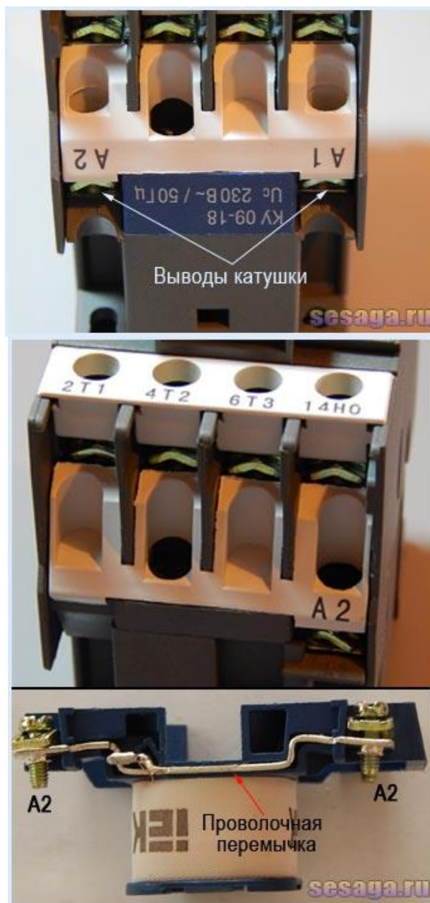
Рисунок 6.10 - Катушка електромагнітного пускатча і її затискачі
