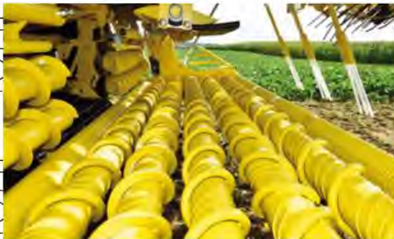
Рис. 2.9. Шнекові вальцеві очисники коренеплодів
