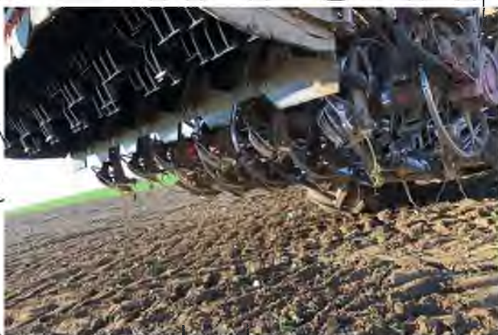
Рис. 2.2. Робочі органи для видалення гички та викопування коренеплодів самохідного бурякозбирального комбайна Terra Dos T4
