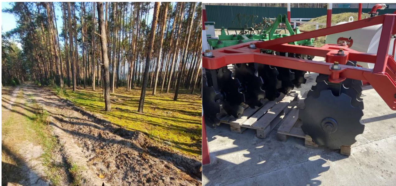
Рис. 4.9. Мінералізована смуга у сосновому насадженні, створена лісовою бороною дисковою ЛБД-1,7
