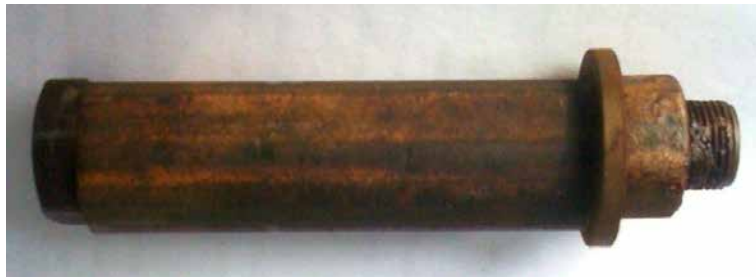
Рис. 3.5 - Різьбова пара в процесі кородування
