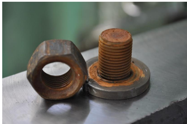
Рис. 3.6 - Різьбова пара після кородування розчином азотної кислоти
