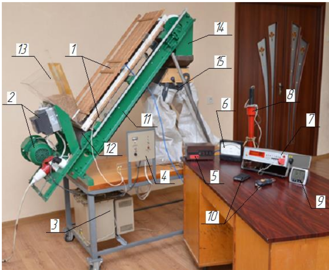
Рис. 3.12 – Загальний вигляд лабораторної установки для визначення енергетичних показників крутосхилого конвеєра з утриманням насіння на стрічці електричною силою поля коронного розряду
