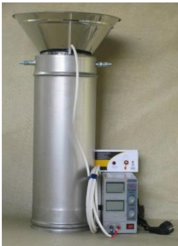
Рис. 2.4 Загальний вигляд установка для передпосівної стимулюючої обробки насіння «ЦИКЛОН 7-3у»
