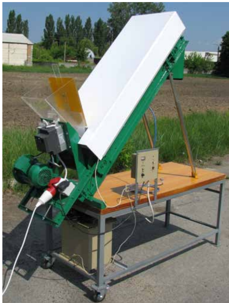
Рис. 3.11 – Загальний вигляд фрагменту крутосхилого стрічкового конвеєра
