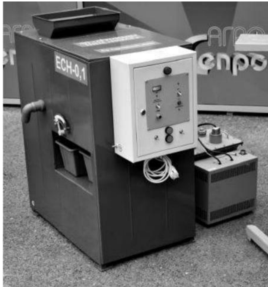
Рис. 3.16 - Загальний вигляд електросепаратора ECH-0,1
