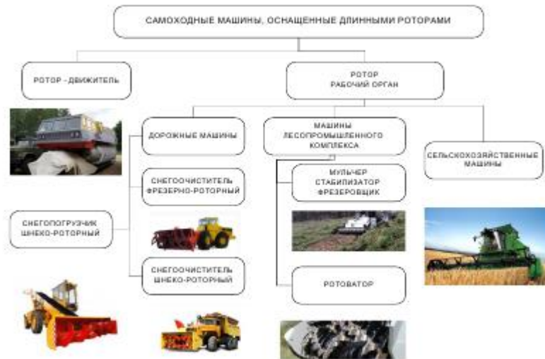
Рис. 1. Структуризація типів машин, оснащених довгими гвинтовими роторами
