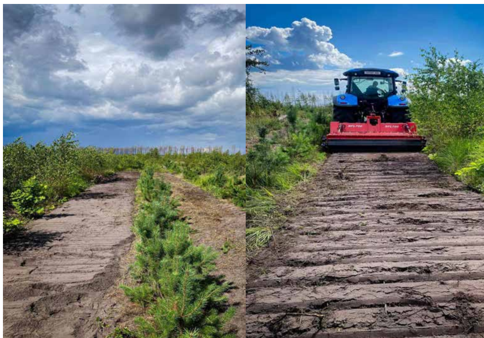
Рис. 5.4. Проведення догляду у міжряддях лісових культур за допомогою мульчувача PRINOTH GRIZZLY M550m
