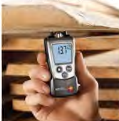
Рис.2.4. Вимірювання вологості пиломатеріалів за допомогою кондуктометричного вологоміру
