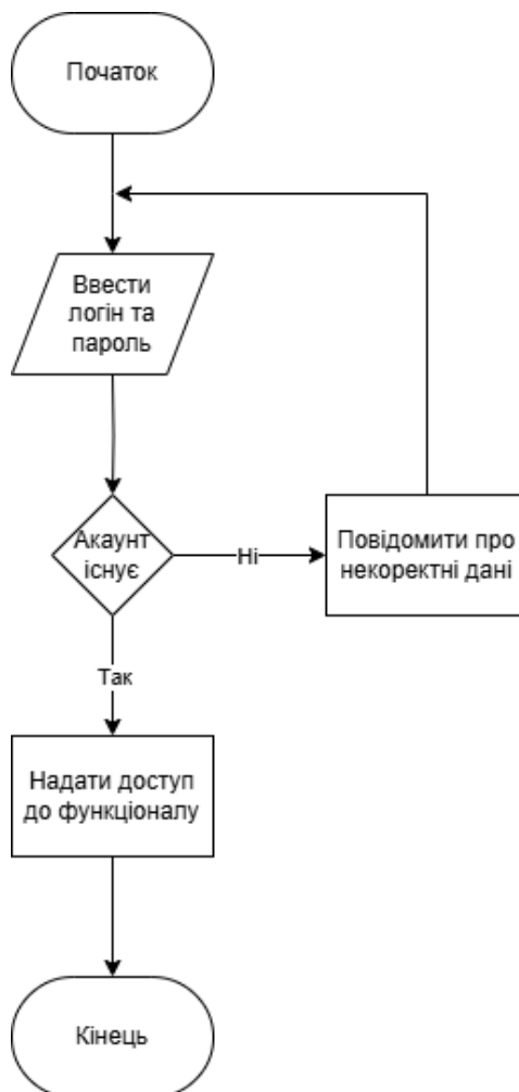
Рис. 3.6.1 – Блок-схема логіки входу користувача в обліковий запис
