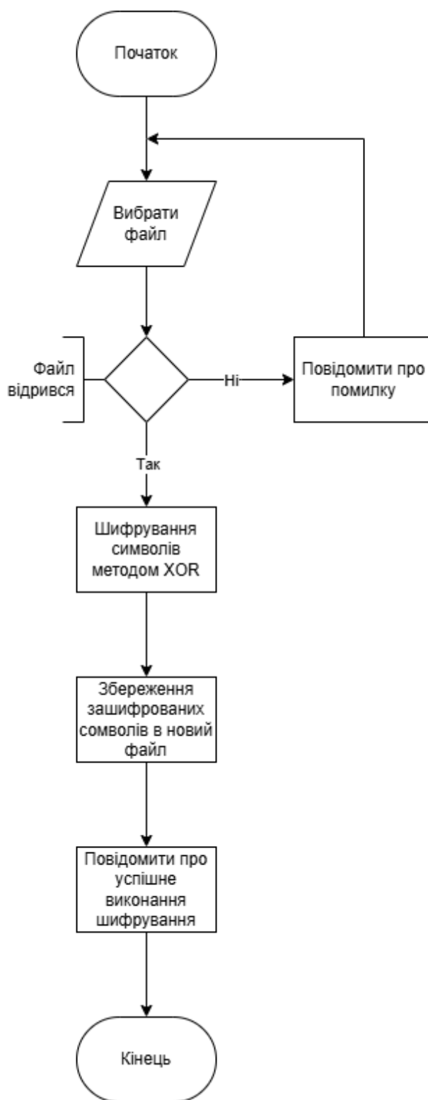
Рис. 3.6.3 – Блок-схема логіки шифрування файла
