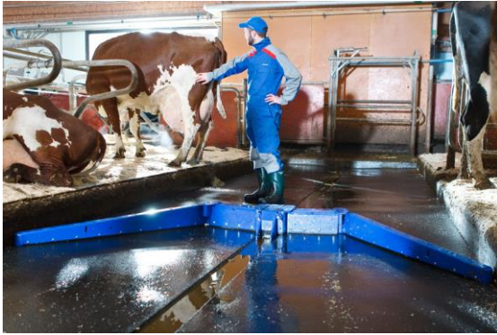
Рис. 3.6. Дельта-скрепер DW компанії Де Лаваль (Швеція)
