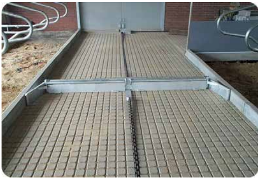
Рис. 3.7. Комбіскрепер виробництва голландської компанії JOZ
