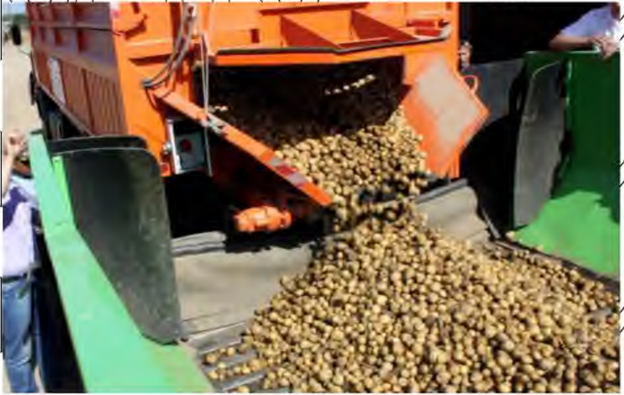
Рисунок 1.7. Транспортний засіб, обладнаний рухомим дном
