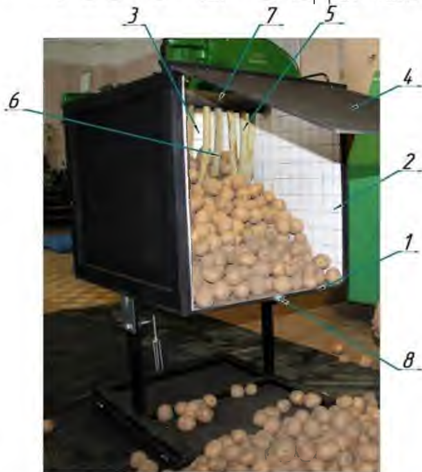
Рисунок 3.2 – Загальний вид контейнера (кузова транспортного засобу), обладнаного еластичною перегородкою: 1 – осто́в; 2 – торцьові стінки; 3 – боковина; 4 – відкидний борт; 5 – поперечна перемичка; 6 – пустотіла трубка; 7 – вісь; 8 – фіксатор.
