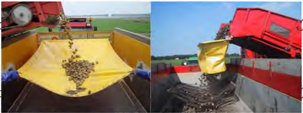
Рисунок 1.10. Гасителі падіння бульб картоплі у кузові транспортного засобу
