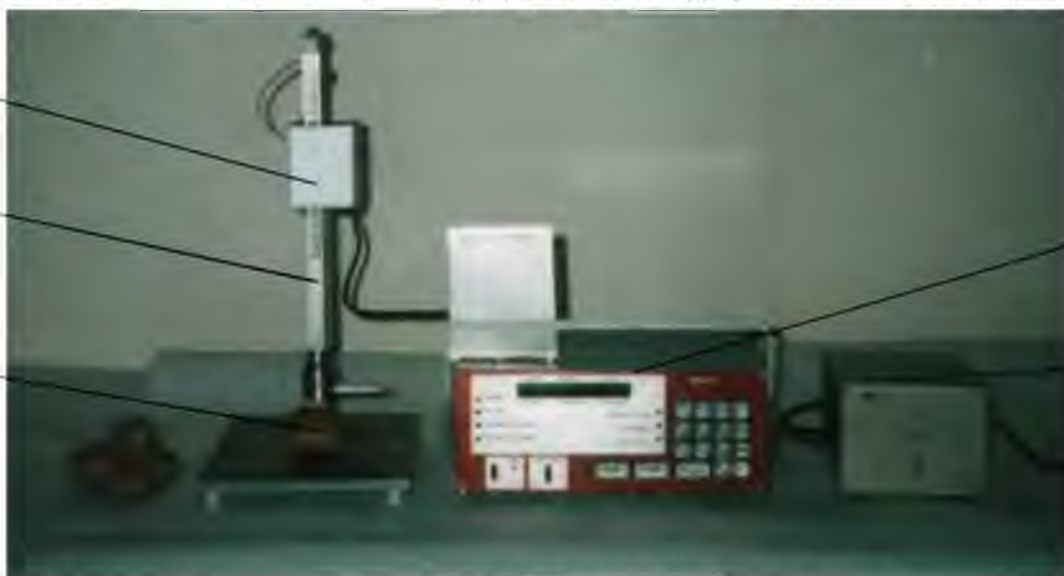
Рисунок 3.1. Прилад "Клубень" ПРГ-40Г. 1 – клубень, 2 – вимірювальний щуп; 3 – вимірювальний блок; 4 – блок керування; 5 – блок живлення.
