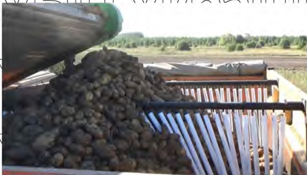
Рисунок 4.8. Завантаження автомобіля МАЗ 5516, обладнаного поперечними еластичними перегородками
