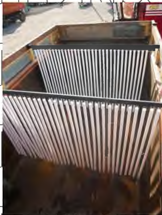
Рисунок 4.5. Загальний вигляд кузова автомобіля МАЗ 5516, обладнаного поперечними еластичними перегородками
