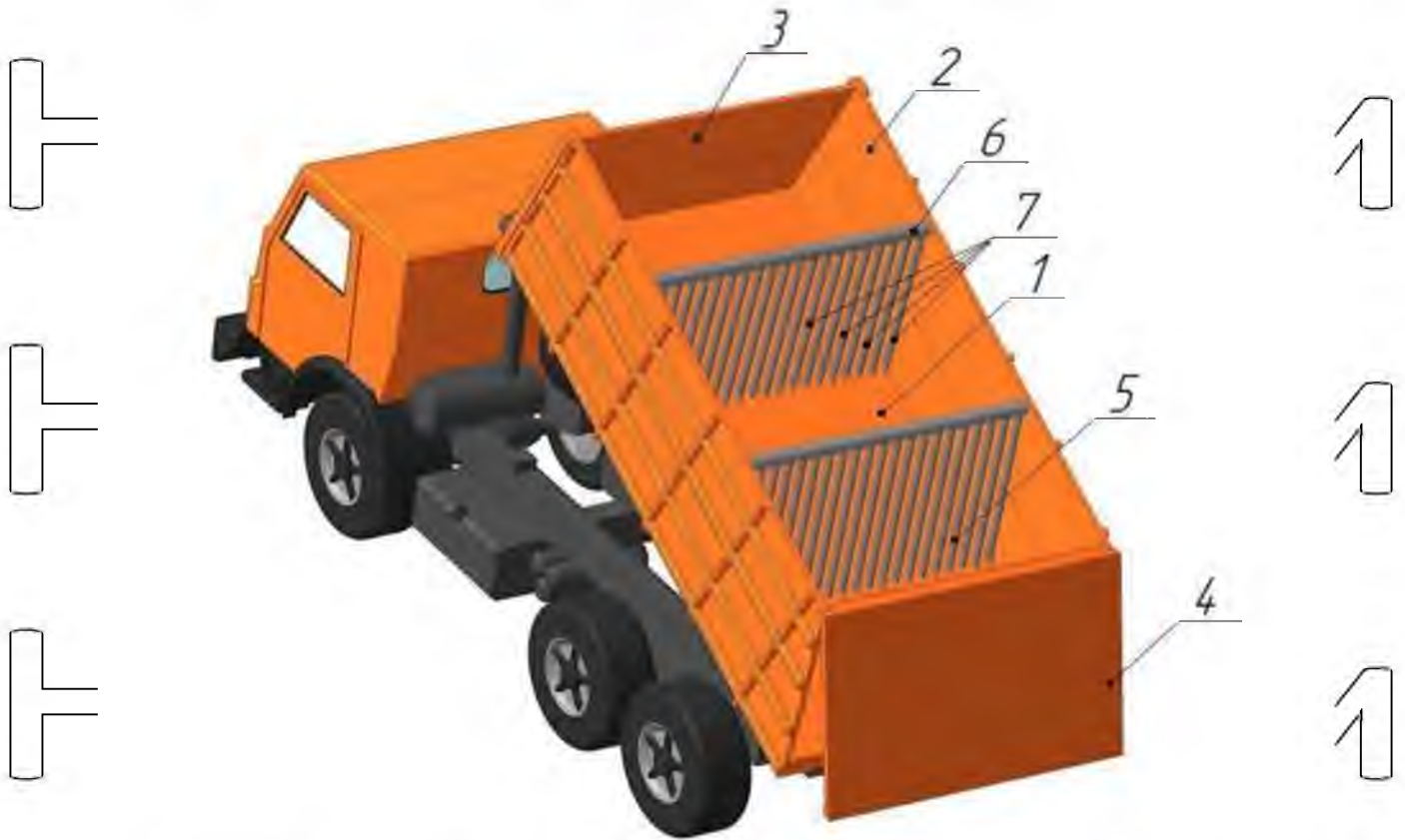
Рисунок 2.2 – Положення еластичної перегородки під час розвантаження:
