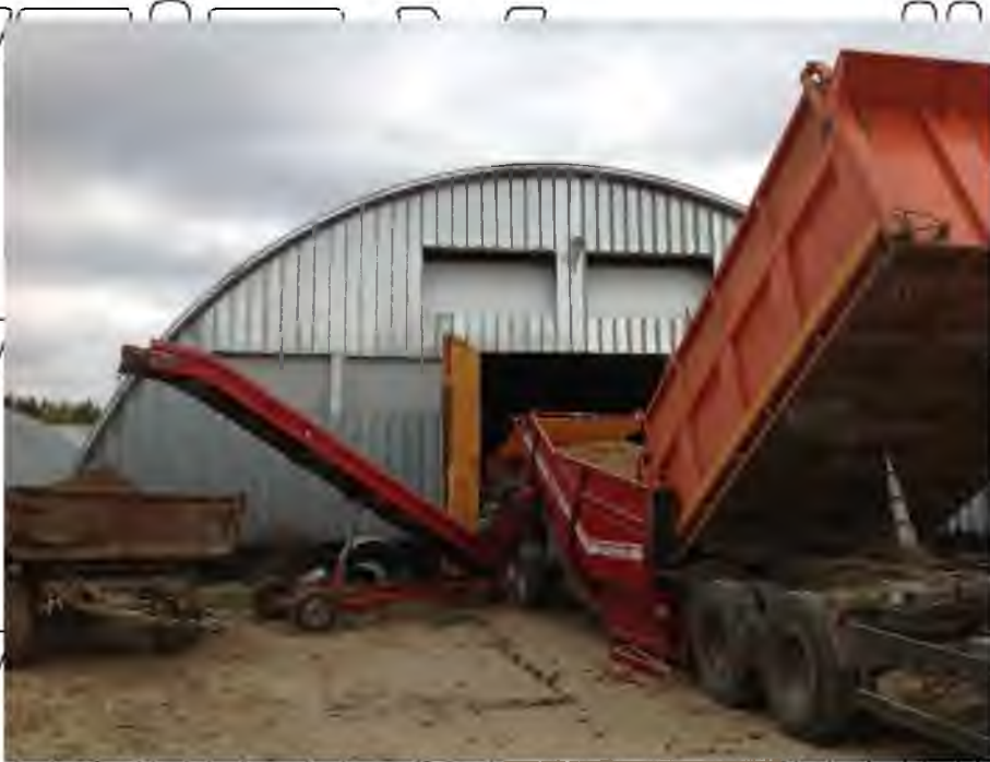
Рисунок 1.10. Гасителі падіння бульб картоплі у кузові транспортного засобу
