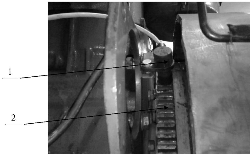
Рисунок 3.8 – Встановлення датчика тиску камери згоряння
