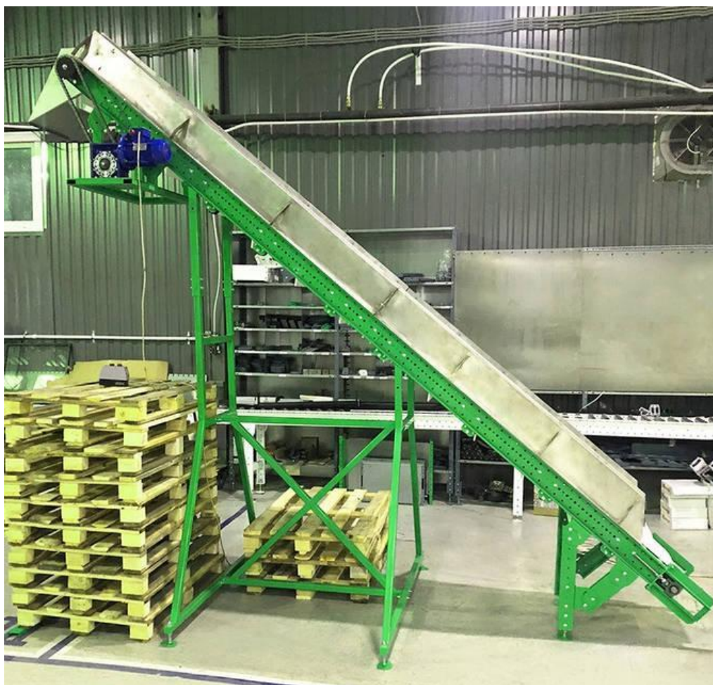
Рис. 1.4. Похилий стрічковий конвеєр для подачі зерна до силосів або верхніх рівнів складу.
