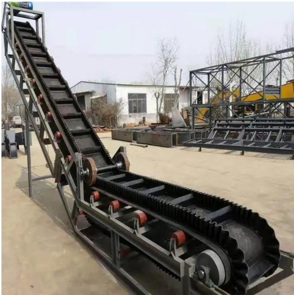
Рис. 1.5. Крутопохилий конвеєр із шевронною стрічкою і гофробортами
