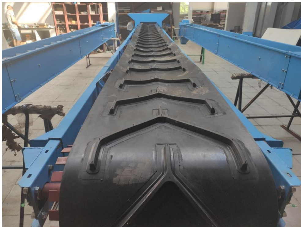
Рис 1.6. Конвеєр з комбінованими шевронами для підйому під кутом
