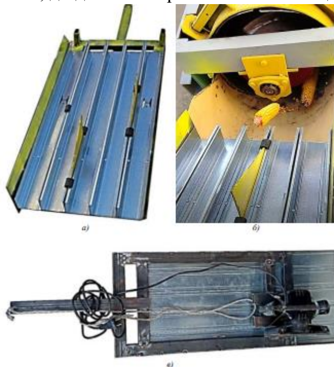
Рисунок 3.5 - Конструктивні особливості запропонованого ОДЗА а – вид зверху; б - схід качанів з ОДЗА паралельно осі ротора МСП; в - розташування вібраційного приводу ОДЗА
