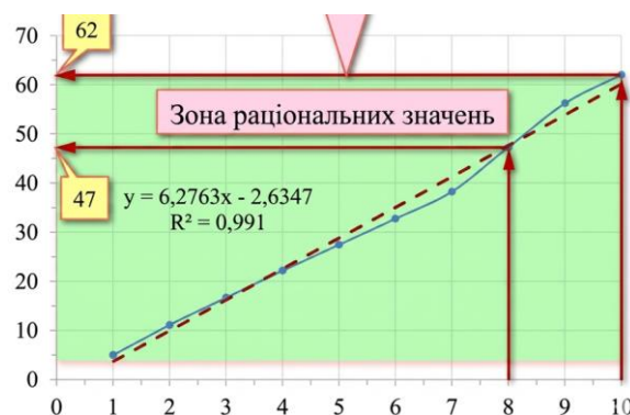
Рисунок 4.1 - Графічна залежність опору вдавлюванню шипа гумову підшву пневмо-подушки товщиною 3 мм від глибини його вдавлювання, за умови внутрішнього надлишкового тиску 0,4 атмосфери
