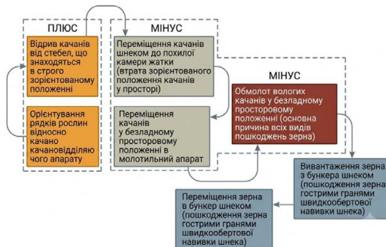
Рисунок 1.3 - Схема опису загальних принципів роботи машин для прямого комбайнування зерна кукурудзи: +/- - науково обґрунтована/не обґрунтована та практично реалізована/не реалізована технічна система орієнтування качанів щодо виконавчих робочих органів
