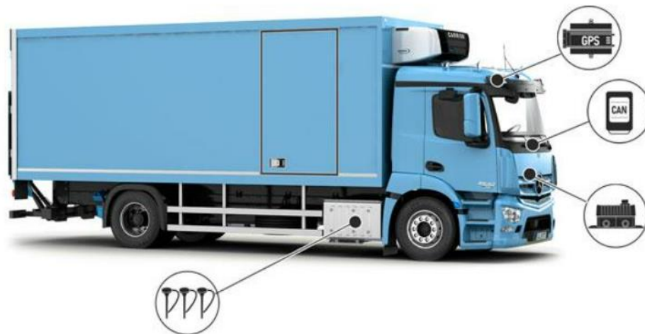
Рис. 4.1. Поєднаний метод контролю палива за допомогою GPS. [22]
