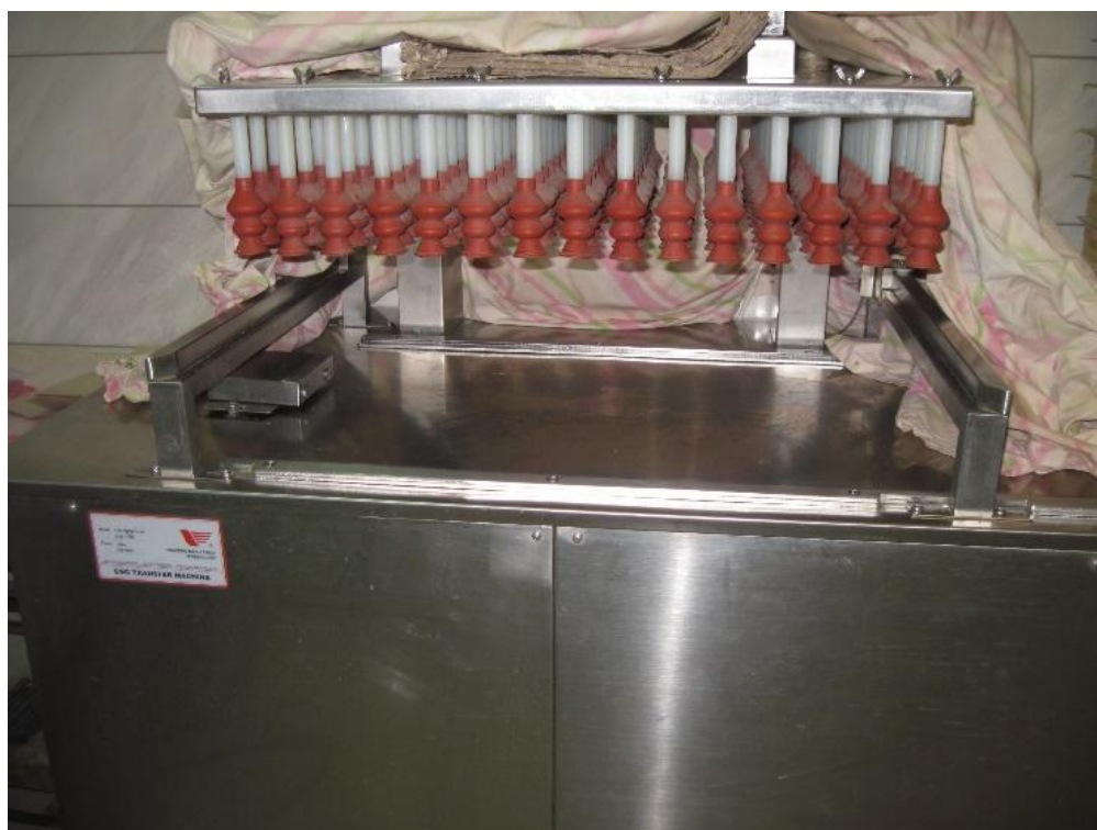
Рис. 2.5. Машина для перекладання яєць (фото надано господарством за погодженням)
