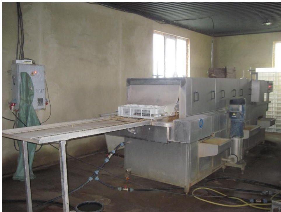
Рис. 2.6. Обладнання для миття лотків (фото надано господарством за погодженням)
