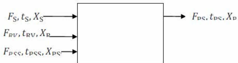
Рис. 2.3.1. Параметрична схема апарату попередньої очистки дифузійного соку
