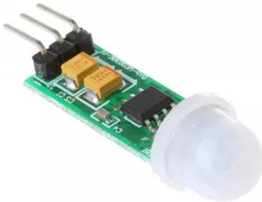
Рисунок 2.13 – Інфрачервоний датчик руху HC-SR505
