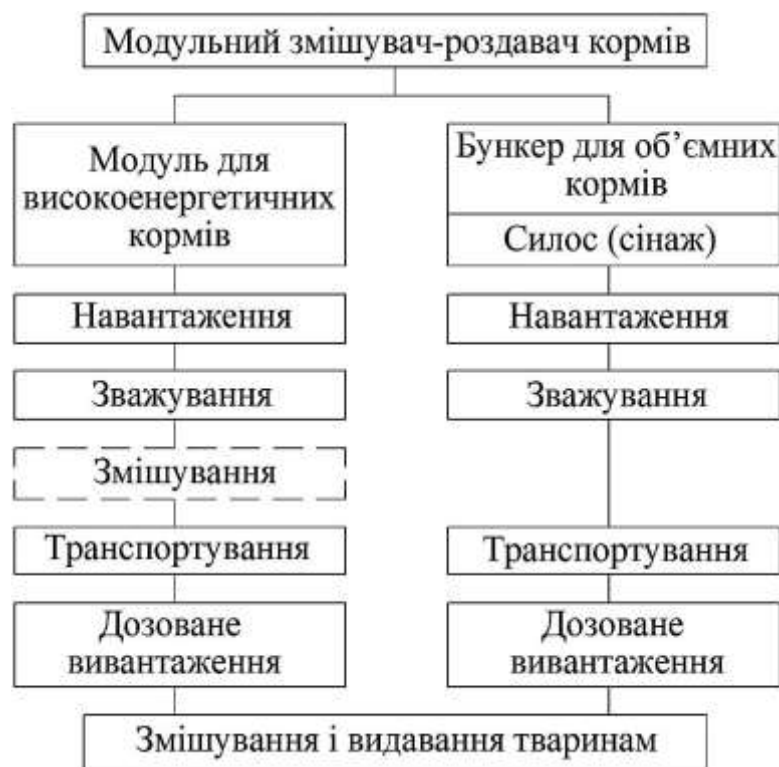
Рисунок 1 – Поопераційна технологічна схема робочого процесу мобільного модульного змішувача-роздавача кормів
