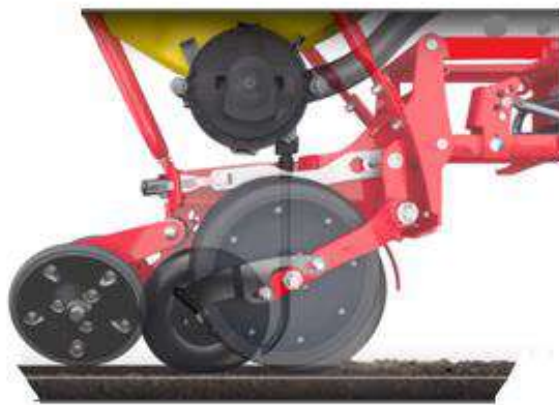
Рисунок 5 – Посівна секція сівалки Тетро F
