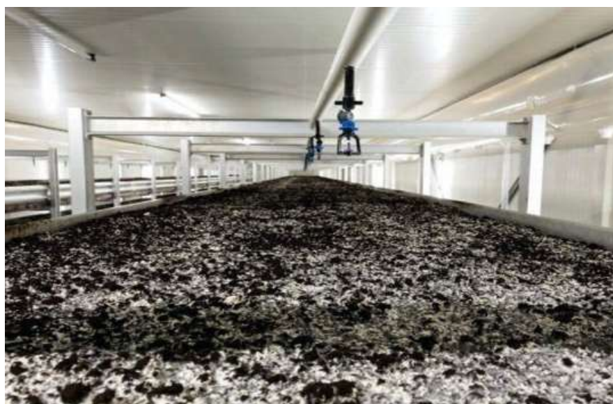
Рисунок 4 – Полив за допомогою трубопроводів
