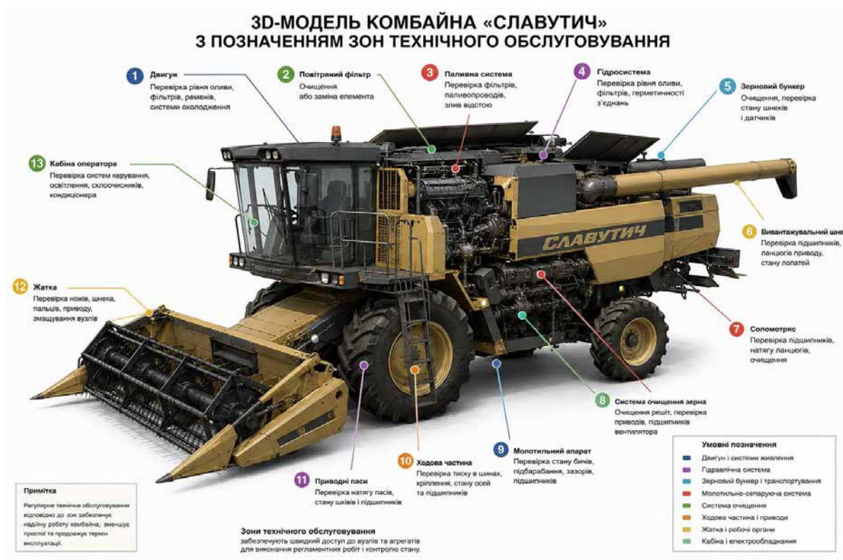
Рис. 1.2. 3D-модель комбайна «Славутич» з позначенням зон технічного обслуговування
