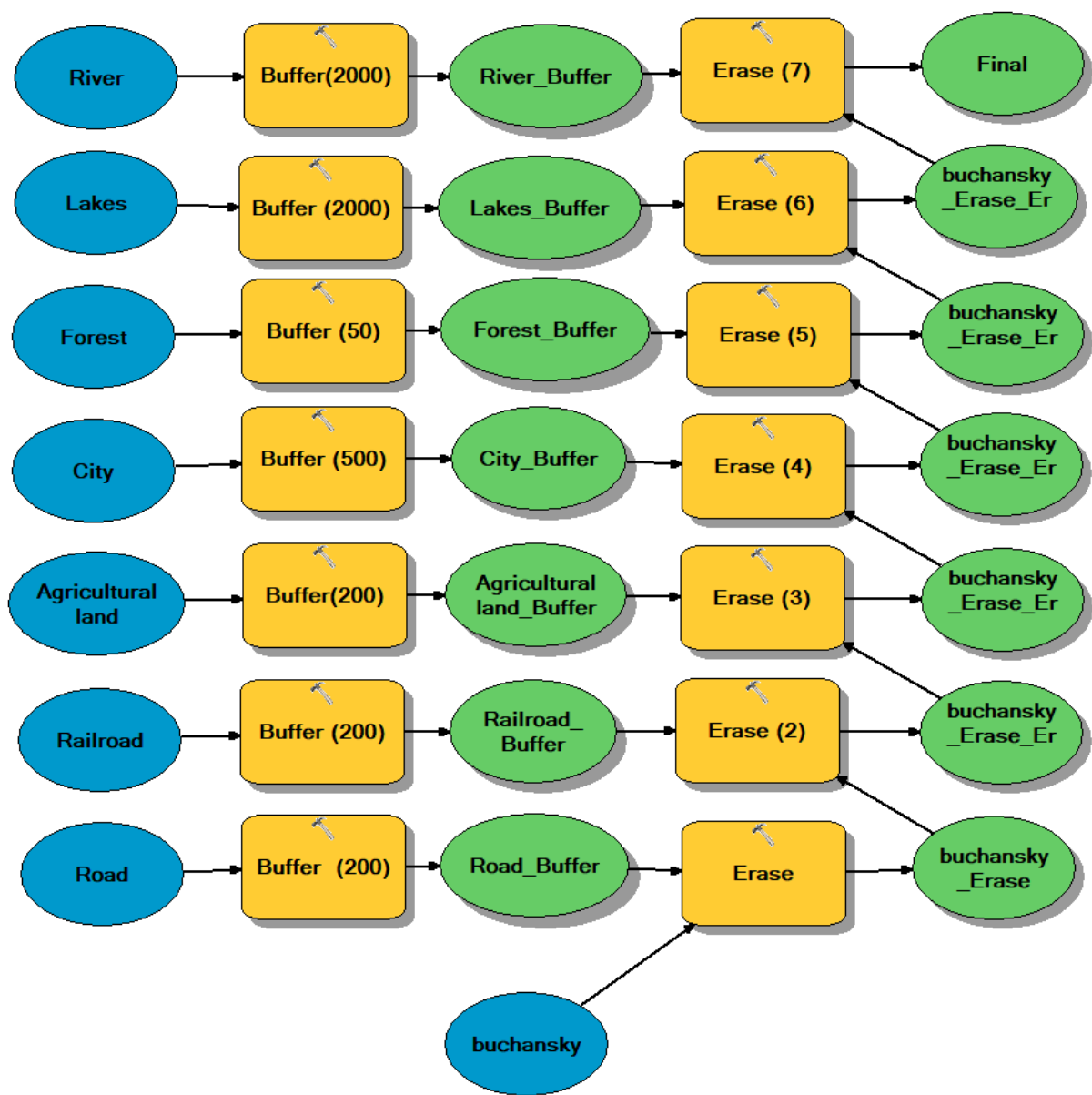
Рис. 3.5 – Модель визначення територій для розташування звалищ відходів, що утворились внаслідок воєнних дій
