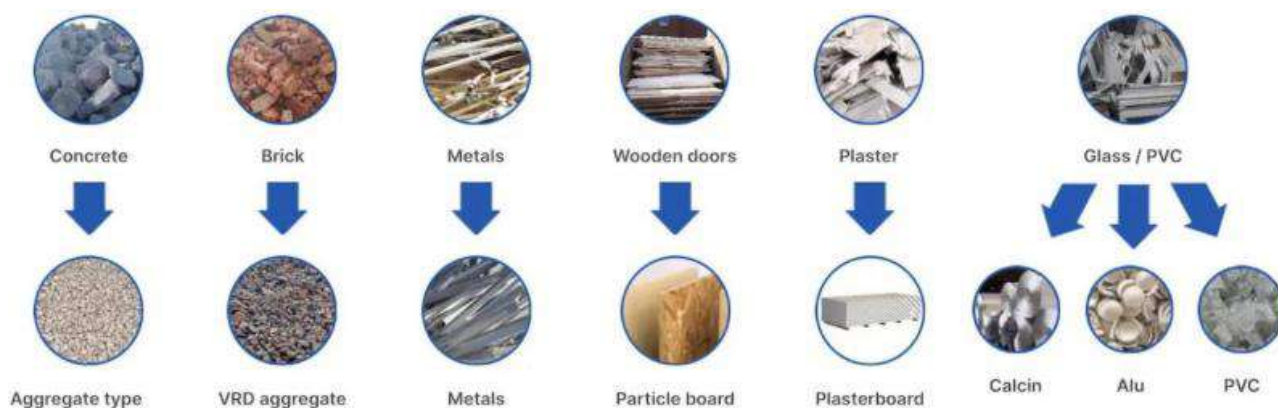
Рис. 1.4 – Схема переробки будівельного сміття на нові матеріали [12].
