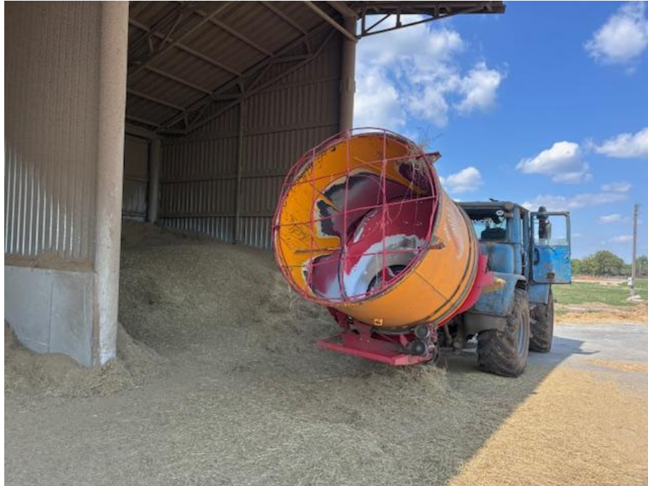
Рис. 3.1.15. Соломорізка для подрібнення грубих кормів та підстилкового матеріалу Tomahawk 505
