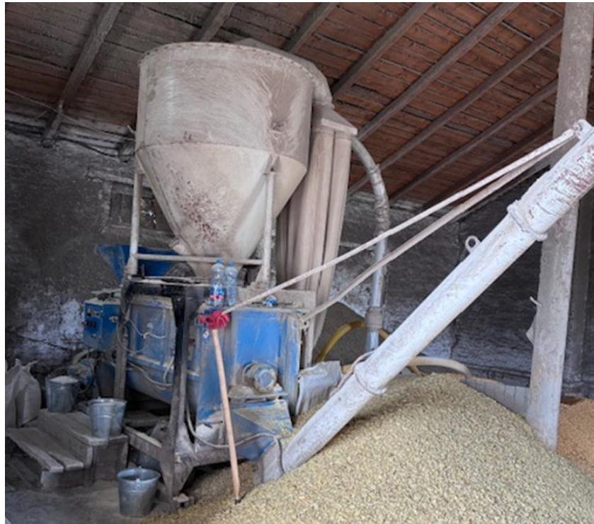
Рис.3.1.8. Загальний вид комбікормової установки МКУ-1,5 яка задовольняє виробничі потреби тваринництва ФГ Филенківське в виробництві повноцінних комбікормів
