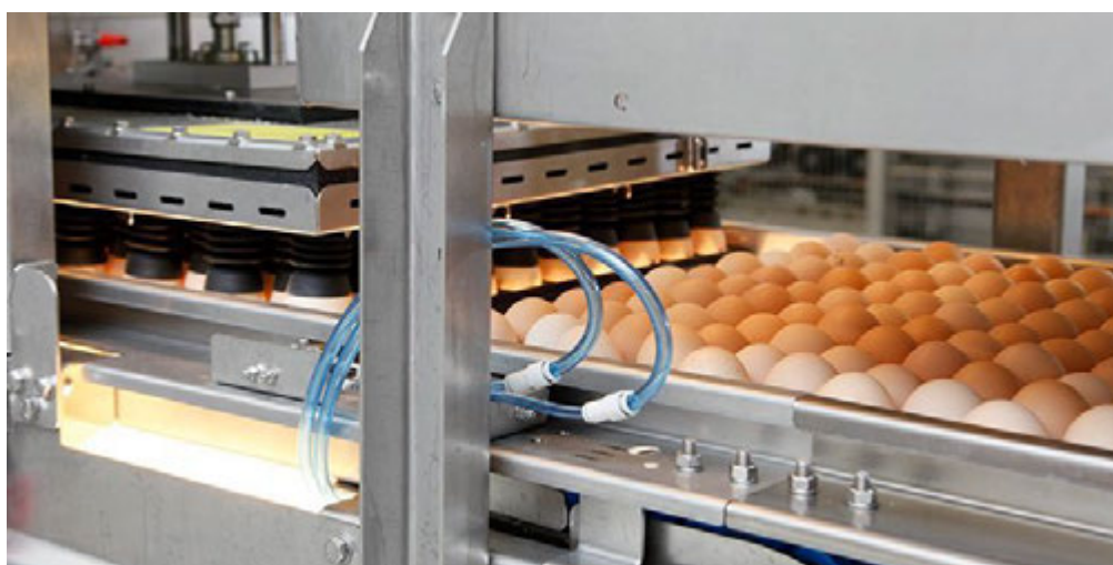
Рис. 2.3. Автоматична установка для овоскопування та одночасного перенесення яєць (Джерело: Pas Reform Hatchery Technologies,
