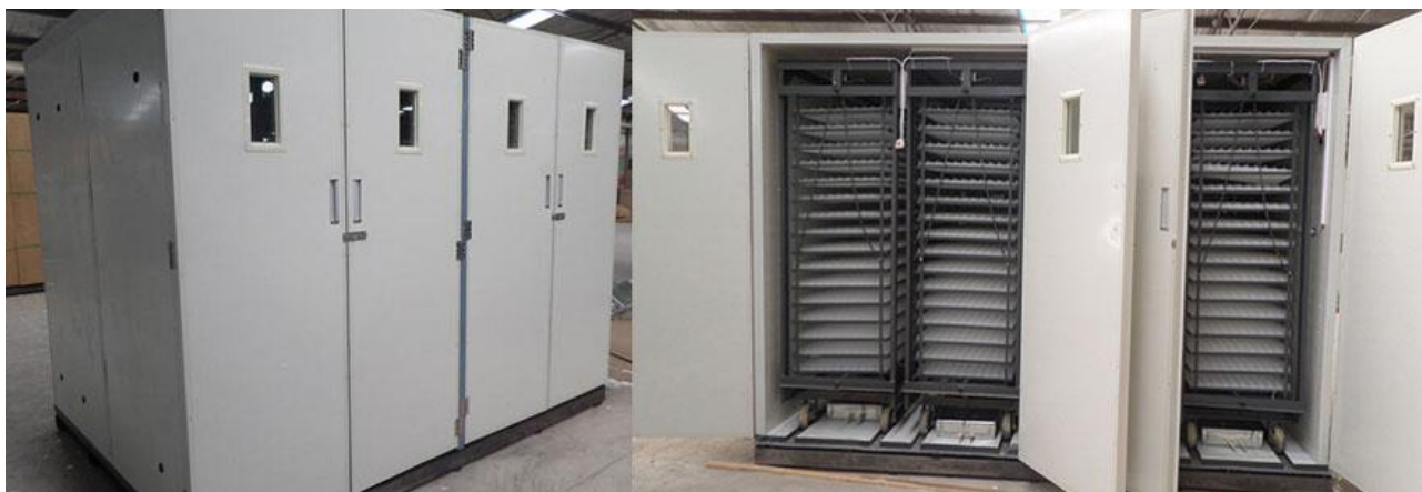
Рис. 2.1. Сучасні промислові інкубатори шафового типу з автоматичними системами повороту лотків, водопостачання та опалення (Джерело: FAMtech, https://chickenscage.com/cabinet-incubator.html )
