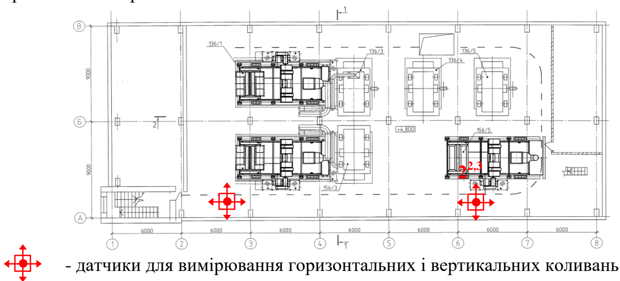
Рис. 3. Розстановка датчиків (акселерометрів) на відм. +4.800 біля грохотів
