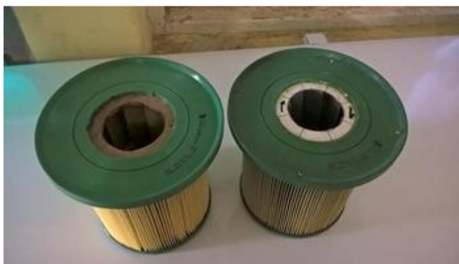
Рис. 3.6. Пристрій повітропідготовки, розміщений у запропонованому повітряному фільтрі.
