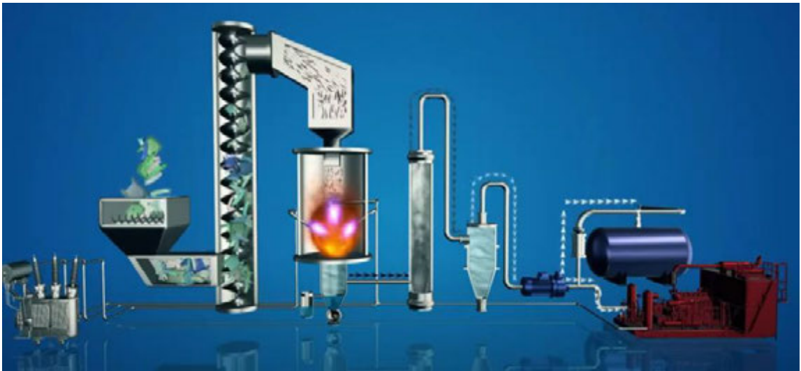
Рис. 1.4. Схема реалізації процесу піролізу в низькотемпературному плазмовому середовищі
