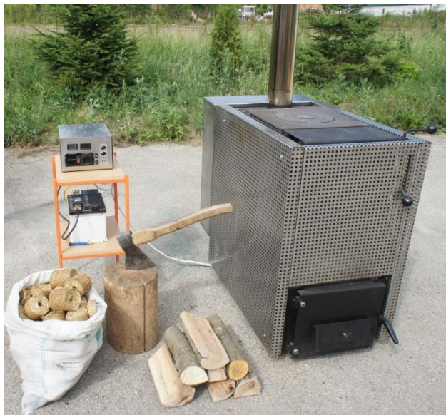
Рис. 13. Дослідний зразок автономної когенераційної системи електроживлення на базі біотеплогенератора.
