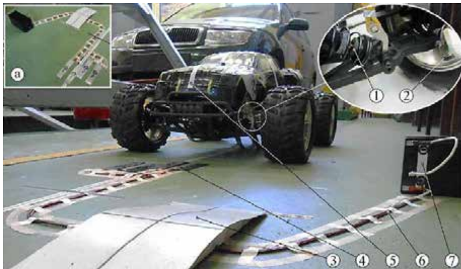
Рис. 4.1. Фізична модель автомобіля та дорожня нерівність, а також джерело енергії з контактною парою (а), що необхідні для роботи виконавчого пристрою активної підвіски
