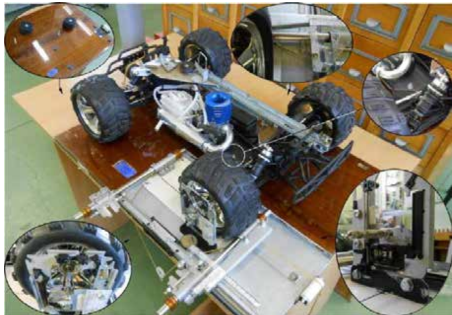
Рис. 4.3. До визначення характеристик еластичного колеса та параметрів його взаємодії з опорною поверхнею
