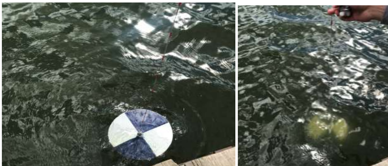
Рис. 3.10. Диск Секкі – прилад для визначення ступеня прозорості води у першому Горіхуватському ставку
