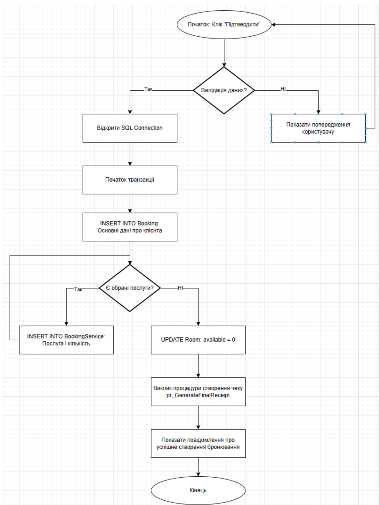
Рис. 14 Блок-схема алгоритму створення бронювання
