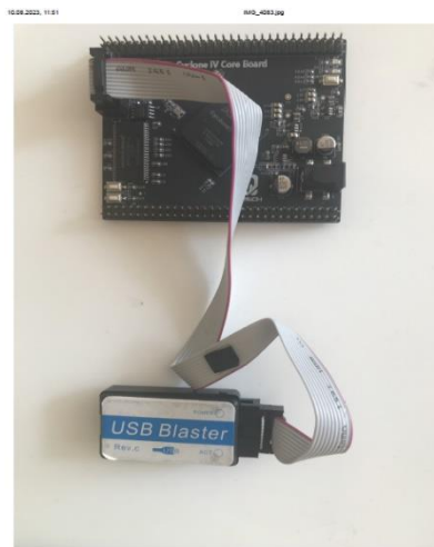
Рис. 4.2. Фото підключення лабораторного столу до персонального комп'ютера через USB Blaster
