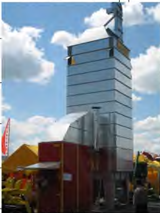
Рис. 1.6. Шахтна стаціонарна сушарка для сушіння зерна кукурудзи Зберігання зерна кукурудзи
