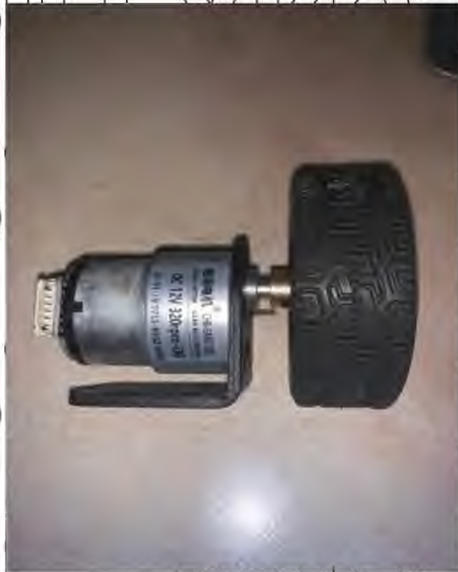
Рис. 2.1 — GM37-520 Мотор-редуктор постійного струму з датчиком Холла 12 В, з тримачами типу L
