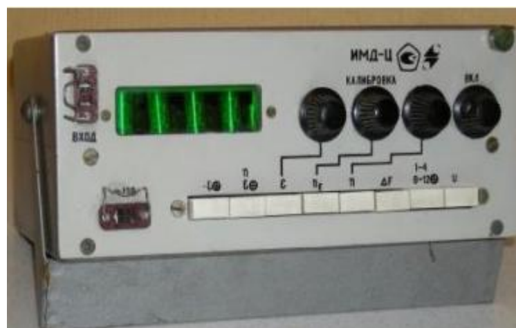
Рис. 1.2. Прилад ИМД-Ц для вимірювання прискорення колінчастого вала двигуна
