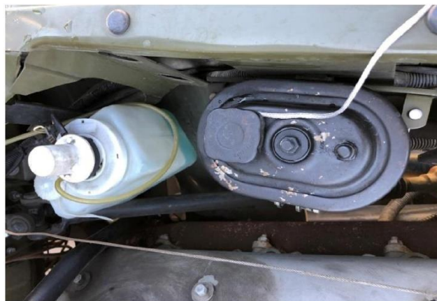
Рисунок 3.8 – Місце вимірювання температури робочої рідини в бачку насоса
