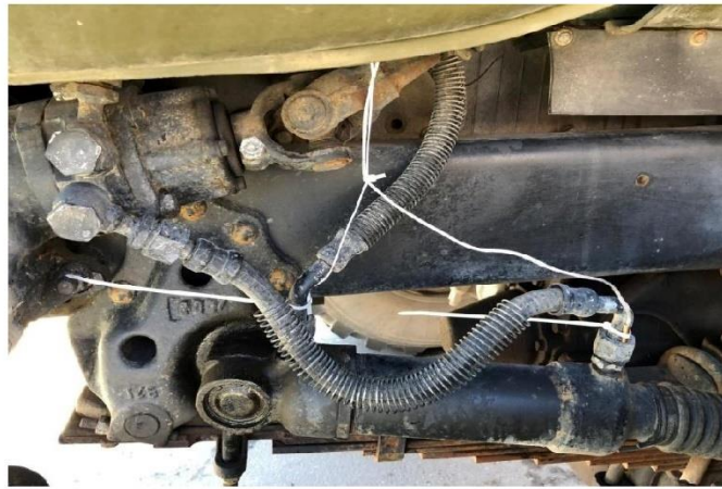
Рисунок 3.7 – Місця приєднання термопар №2 і №3 до трубопроводів силового циліндра
