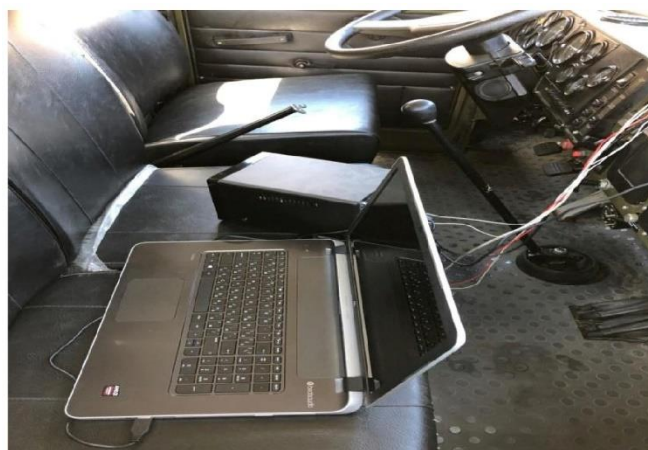
Рисунок 3.9 – Розміщення контрольно-вимірювального комплексу Джерелом живлення інтегрованої вимірювальної системи є бортова система живлення 24 В, Урал 4320-0010-31, тримач для письмової електроніки
