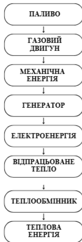
Рис.1.2. Принцип роботи газопоршневої когенераційної установки
