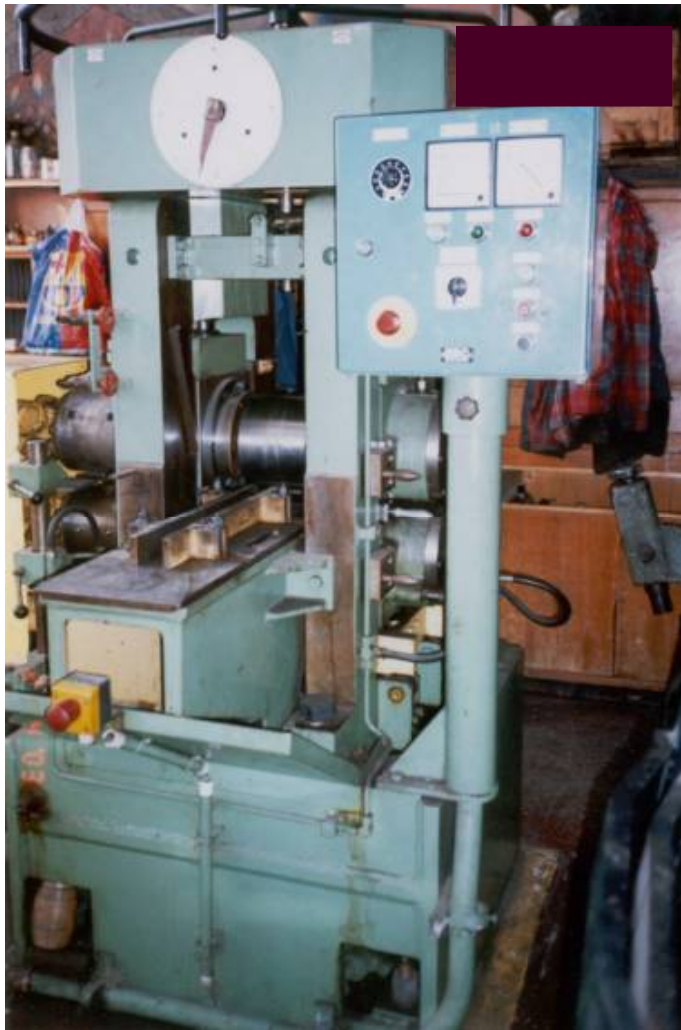
Рис.7.18. Загальний вигляд прокатного станка для виготовлення стрічки товщиною h_{\min} = 0,15 мм
