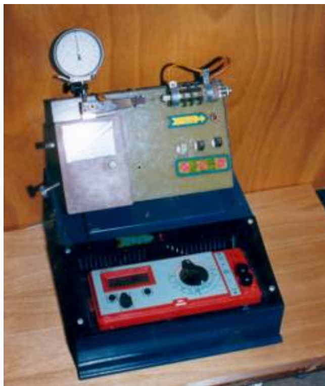
Рис.7.13. Загальний вигляд станда для експериментальних досліджень температури спрацювання термореле залежно від зазора між контактами
