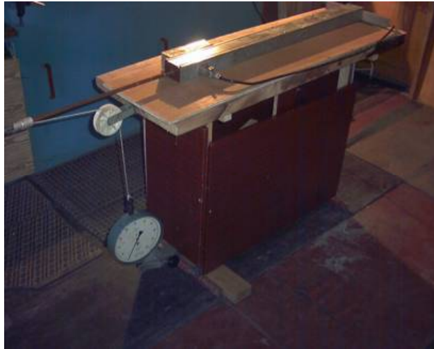
Рис.8.39. Дослідна установка для визначення зусилля електротермомеханічного приводу
