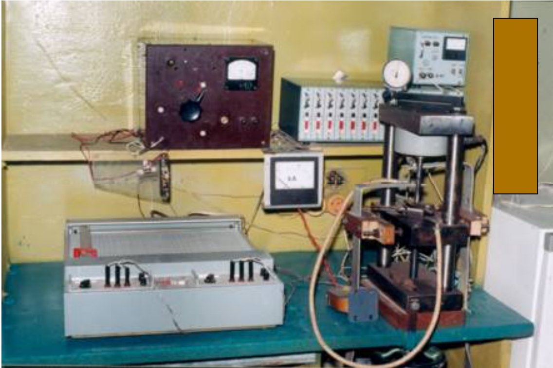
Рис.7.24. Загальний вигляд станда для експериментальних досліджень конічних шайб із сплаву з ефектами пам'яті форми та надпружності
