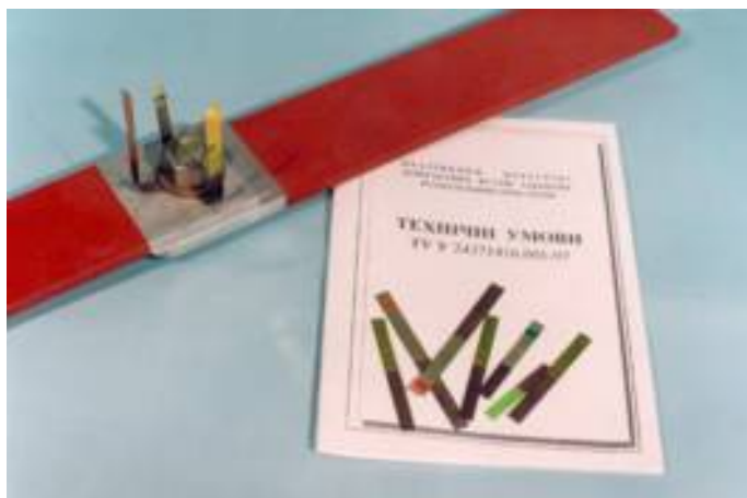
Рис.7.2. Загальний вигляд розбірного контактного з'єднання алюмінієвих шин із вказівниками перегрівання
