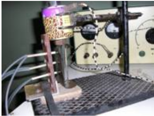
Рис.8.10. Установка для визначення коефіцієнта теплопровідності:
