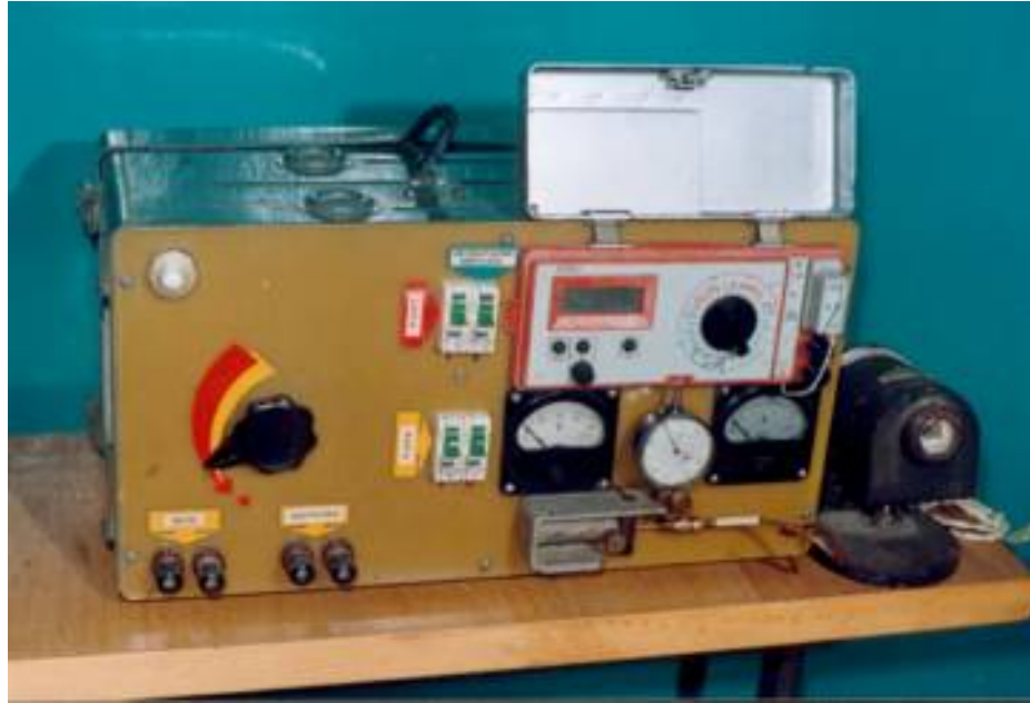
Рис.7.16. Загальний вигляд станда для експрес-аналізу сплаву під час плавлення
