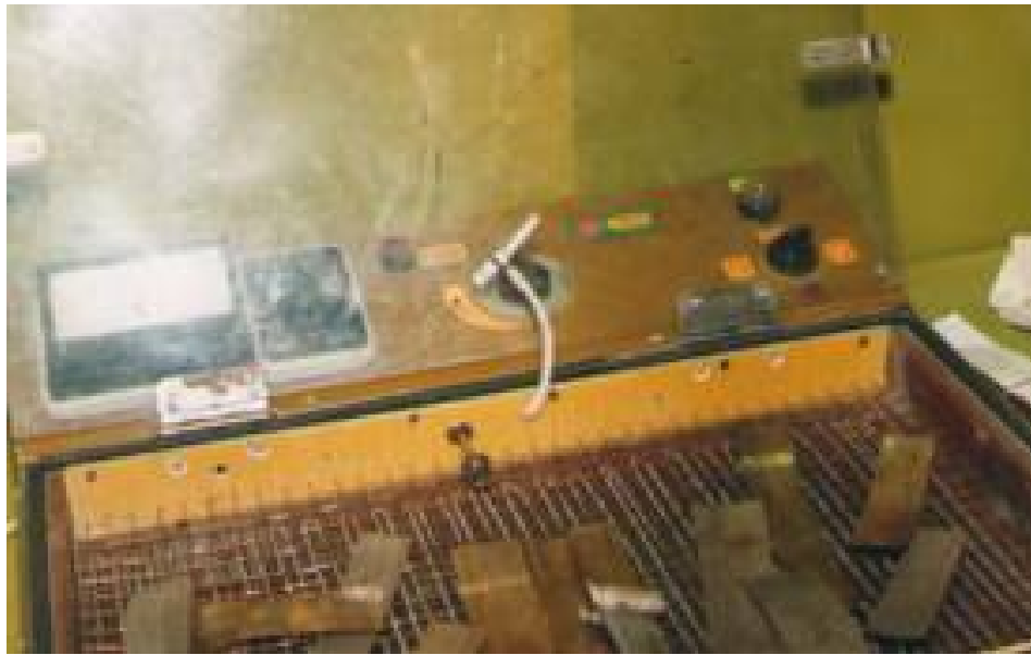
Рис.7.19. Загальний вигляд станда ССТП для сортування смуг тонкого прокату
