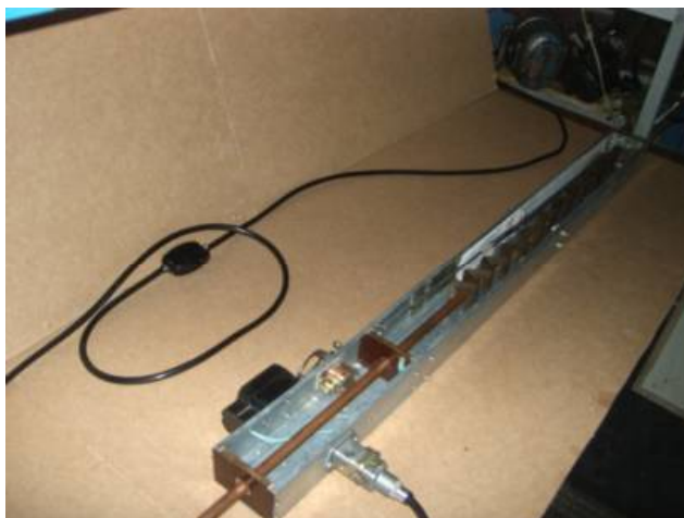
Рис.8.37. Електротермомеханічний привод на основі ФС
