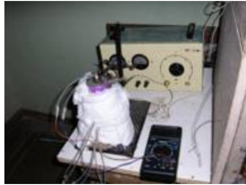
Рис.8.10. Установка для визначення коефіцієнта теплопровідності:
