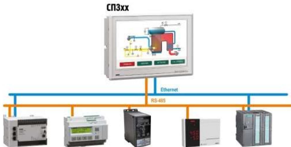
Рис. 6.2. Структура організації НМІ за допомогою СП310 ОВЕН
