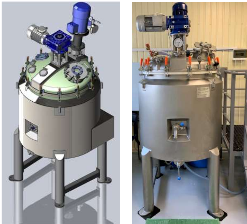
Рис. 1.5. Зовнішній вигляд реактора вакуумного із гомогенізатором "Проект 2586"
