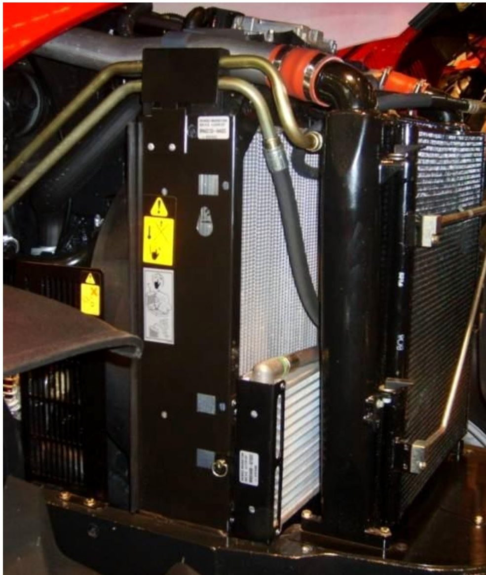
Рисунок 1.4 – Конструктивне виконання компоновки радіаторів трактора «CASE» на прикладі моделі MAXXUM 140 Multicontroller потужністю 104 кВт
