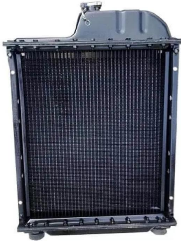
Рисунок 2.4 – Уніфікований мідний водяний радіатор
