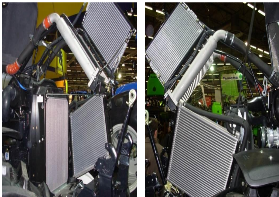
Рисунок 1.11 – Блок теплообмінників трактора «NEW HOLLAND T7060»
