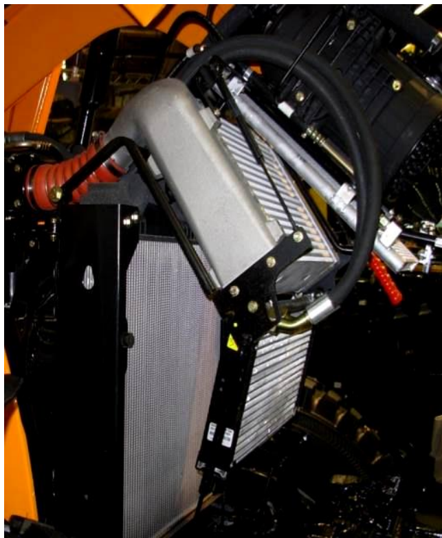
Рисунок 1.7 – Радіаторний відсік трактора фірми «MASSEY FERGUSON» на прикладі моделі 6465Пройшовши через перший ряд радіаторів, повітряний
