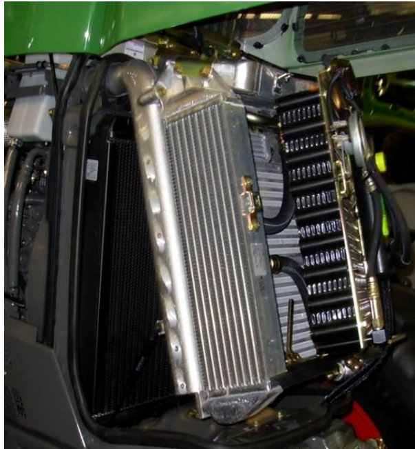
Рисунок 1.6 – Конструктивне виконання компонування радіаторів трактора «FENDT» на прикладі моделі Vario 820 потужністю 150 кВт
