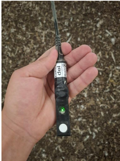
Рис. 3.3. Датчик вимірювання відносної вологості повітря «DOL 114»
