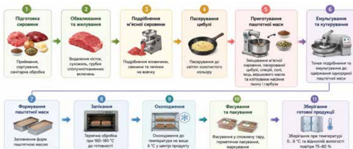
Рис. 3.3 . Технологічна схема виробництва м'ясного паштету з використанням клітковини насіння олійних культур
