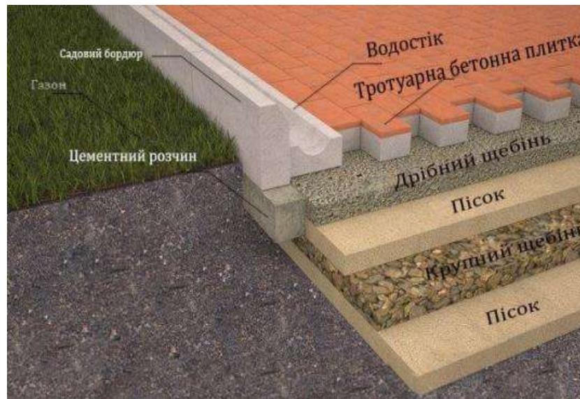
Рис. 4.4. Схема укладання доріжки з ФЕМ [12]
