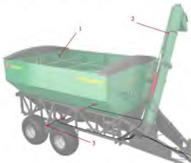
Рис.2.8. Бункер-перевантажувач: 1 – бункер; 2 – вивантажувальний шнек; 3 – тензодатчик.
