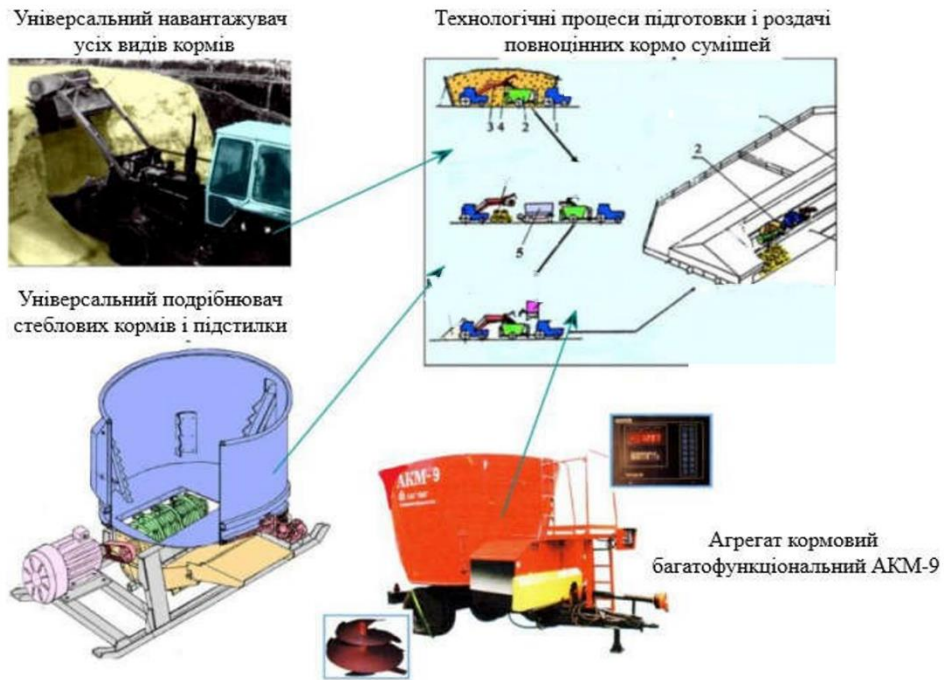
Рис. 1.1. Технологія і обладнання кормових ліній з використанням мобільних подрібнювачів-роздавачів кормів
