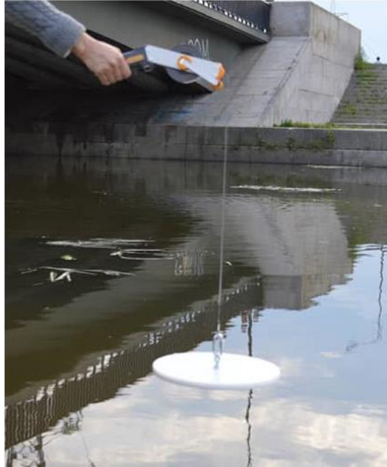
Рис.3.7 Прилад для вимірювання прозорості води
